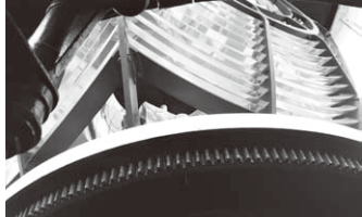
巨大なフレネルレンズ。奥に光源ランプが見える
